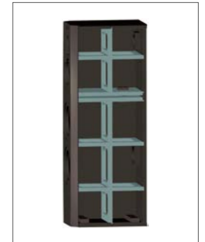
トゥイーター/ミッドレンジ部とウーファー部を2枚の板で遮断し、独立した容積を確保した2BOX構造のエンクロージャー
