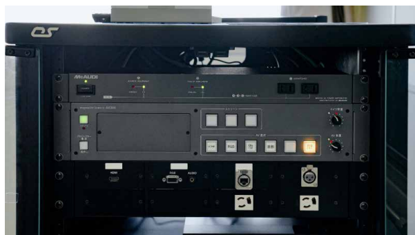
ラック内がスッキリし、高い操作性を持つ AV コントローラー AV03DS
