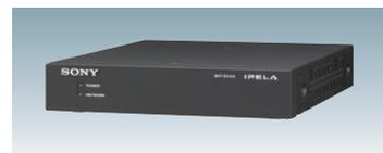
● **アナログ信号を変換し、ネットワーク経由でNSRでモニタリング/記録可能**
