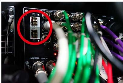
カメラコントロールユニット HDCU-5500 背面左上にオプション装備された ST 2110 インターフェースキット HKCU-SFP50 の IP インターフェース接続部（赤丸内）。
