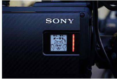
カメラ本体側面に搭載された電子ペーパーとタリールランプ。CCU から表示を更新できる電子ペーパーは、カメラ番号の表示だけでなくロゴやイメージキャラクターを表示させるなど、便利に活用。
