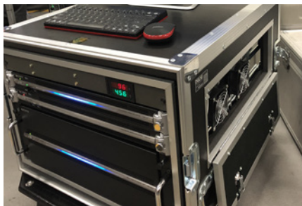
可搬型ラックに収められたプロダクションビデオサーバー。上からメディアゲートウェイステーションPWS-110MG1、コントロールステーションPWS-110PR1、PWS-4500本体
