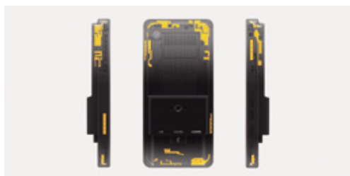
通信性能を高めるためのアンテナ構造と配置
