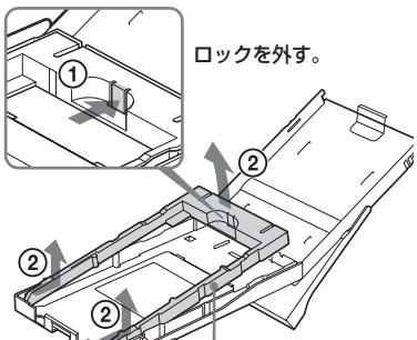
トレイアダプターを取り付けるにはトレイアダプターのツメをトレイ先端の穴に合わせて(①)、アダプター後部のツメがロックする位置まで下ろします(②)。
