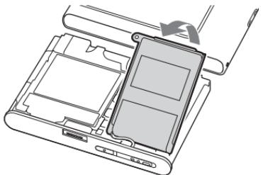
6 本体と電池を接続しているコードを引き抜き、接続部を外して電池を取り出す。
