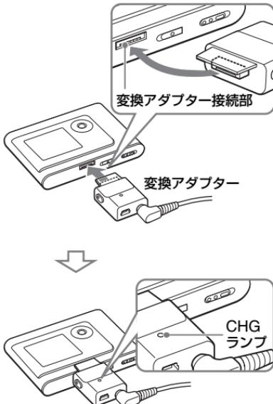
充電は約3時間\*で終わり、CHGランプが消えて、本体の電源が入っている場合は表示窓に稲妻マークが点灯します。急いで充電したい場合は、表示窓が消えた状態でかつ、USB接続ケーブルを抜いた状態で充電すると、約1時間\*で約80%充電されます。
