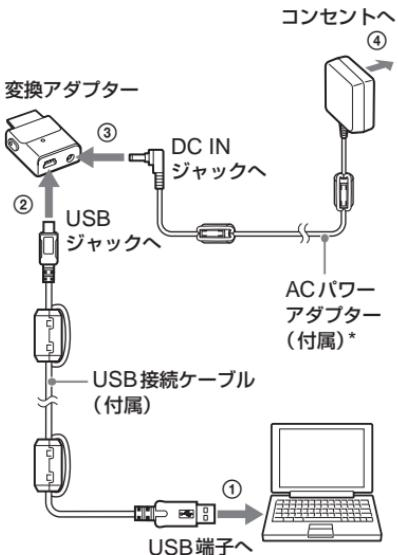
\* 音楽データ転送時には、必ず変換アダプターにACパワーアダプターを接続してください。接続しないと転送できません。
