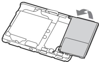
8 本体と電池を接続しているコードを引き抜き、接続部を外して電池を取り出す。
