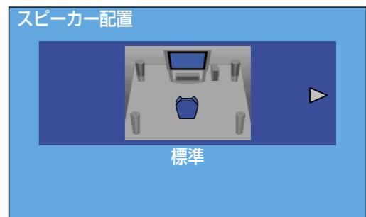
leftrightarrowを使って実際のスピーカーの設置場所と同じスピーカー配置のイメージ画面を選び、ENTERボタンを押す。
