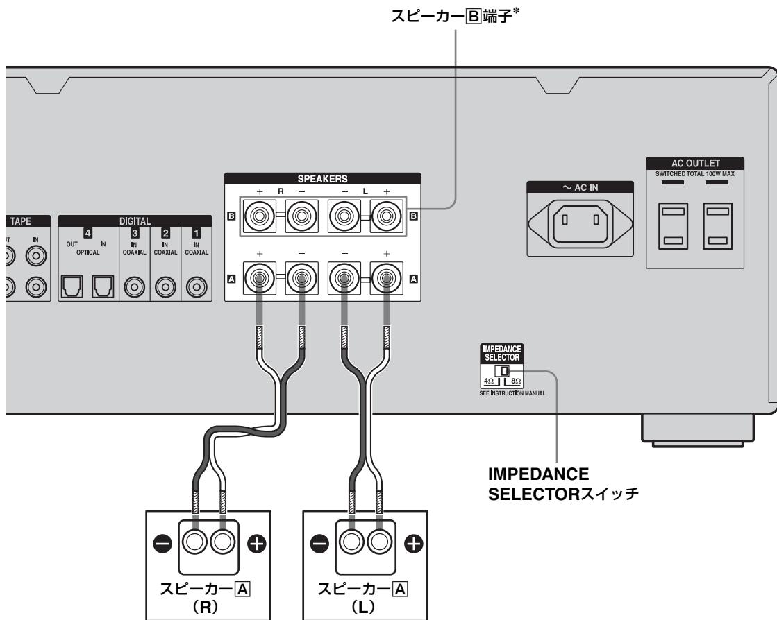
\* 追加のスピーカーシステムを使用するときは、SPEAKERS B 端子につないでください。使用するスピーカーは本機前面の SPEAKERS スイッチで選べます（10 ページ）。
