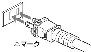
付属の電源コードには、上の図のようにN極側に△マークがあります。これはよりよい音質にするために、壁のコンセントの差し込み口との極性を合わせるためです。壁のコンセントの差し込み口に長短がある場合は、長い穴がN極側です。長短がない場合は、極性がわかる市販の検電ドライバーで調べます。
