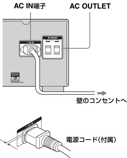
本機背面に電源コードを奥まで差し込んでも、プラグと本機背面の間に数ミリの隙間ができますが、これで正しくつながっています。
