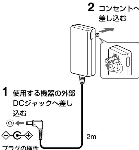
このACパワーアダプターは、極性統一形プラグ（JEITA規格）を使用しています。DC INジャックに $\ominus\oplus$ の極性表示がついている機器に使用してください。この表示がついていない機器または他の極性表示のついた機器に使用すると、故障の原因になることがあります。
