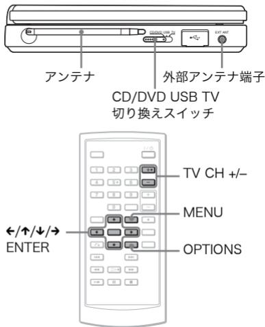
1 本体左側面のアンテナをのぼし、向きを調整する。
