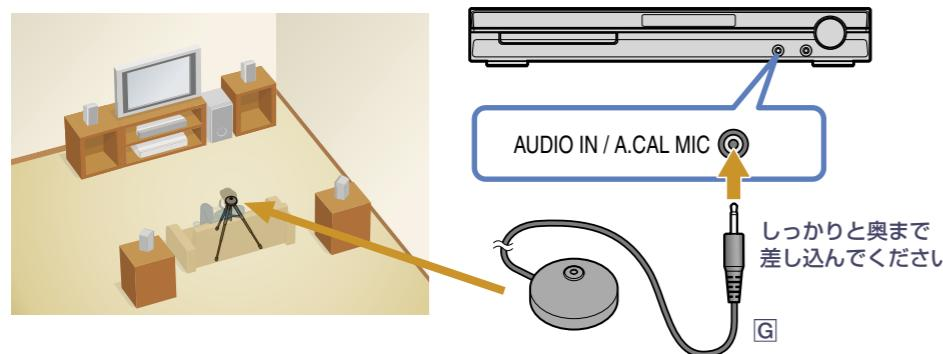
測定マイクを、本体前面のA.CAL MIC端子に接続する。
