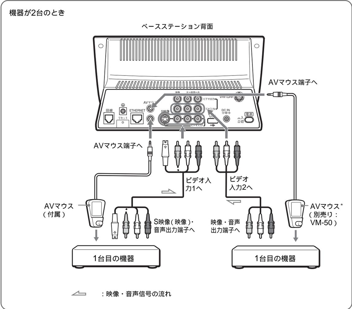
\* 1台のAVマウスのリモコン発光部が2台の機器のリモコン受光部にあたるように設置すれば、別売りのAVマウスを使わずに、付属のAVマウス1台だけで他の機器をコントロールすることも可能です。
