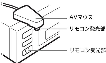
1台のAVマウスで2台の機器をコントロールするときは、AVマウスと機器を以下のように配置します。
