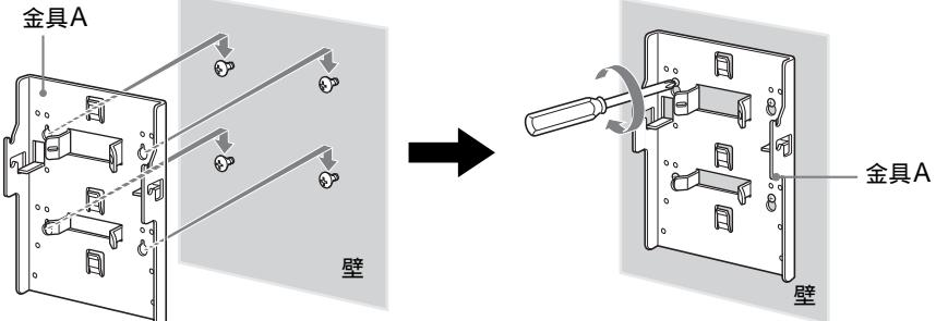
3 ①~④の順にネジ穴にネジAを4本しっかりと取り付ける。
