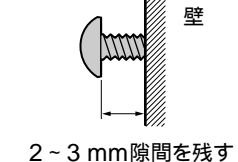
2 金具Aを壁に押し当て、下にずらす。次に壁に固定された4本のネジAをしっかりと締める。
