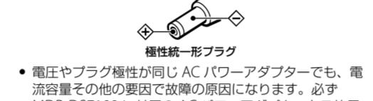
・電圧やプラグ極性が同じ AC パワーアダプターでも、電流容量その他の要因で故障の原因になります。必ず MDR-DS7100 に付属の AC パワーアダプターをご使用ください。
