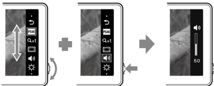
**4** 操作ダイヤルを回して設定内容を選び、ダイヤルを左に押し込む。
