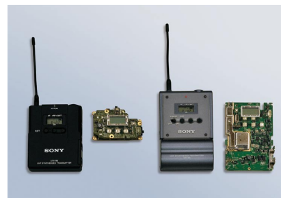
送信機内部の構造比較(左がUWP-V1、右がUWP-C1)
