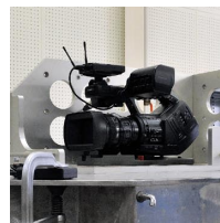
商品単体ならびにカムコーダーに装着しての振動試験
