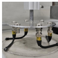
受信機のアンテナ屈曲試験 (写真はWRRシリーズの一例)
