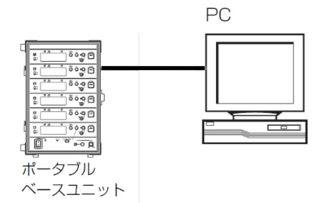
2. PB-01 の電源を入れ、CONFIGURATION -> CONFIG OTHER -> PB IP ADDRESS で PB-01 の IP アドレスを確認します。
