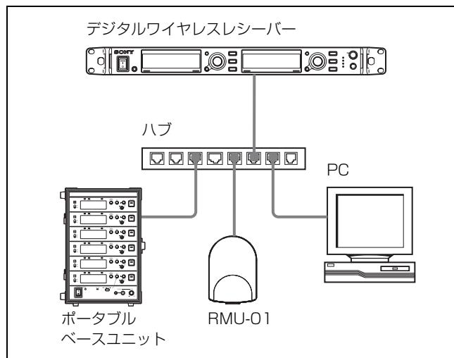
デジタルワイヤレスレシーバー、ポータブルベースユニット、RMU-01、およびPCを、ストレートLANケーブルを使用してハブ経由で接続します。ネットワークを正しく認識すると、デジタルワイヤレスレシーバー、ポータブルベースユニットのリアパネル上のLAN端子のインジケーターが緑色に点灯します。
