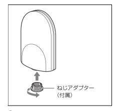
3 マイクロホンスタンドの先端に本機のマイクロホンスタンド取り付け用穴を合わせて差し込み、回して固定する。
