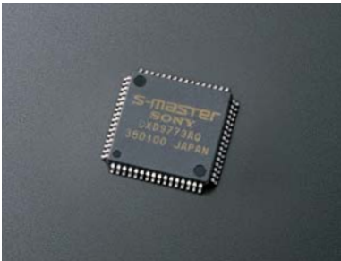
■高音質化を実現したS-Master PROを増幅素子に採用
