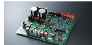
■メイン基板は音の入り口から出口までコネクターを一切使わず音質劣化を抑えました
