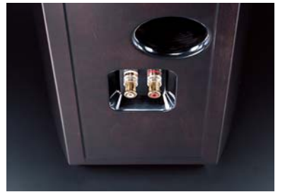
■ウーファーにかかる背圧・ポートノイズに配慮しオフセット配置したバスレフポート
