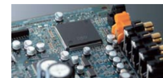
■高精度なアナログ変換を可能にするスーパーオーディオD/Aコンバーター基板
