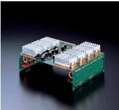
■S-Master PROを搭載した小型で高効率のアンプブロック
