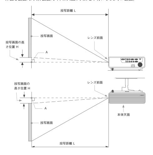
レンズシフト量は初期投写位置からどれくらい動かせるかを投写画面の「全高」 または「全幅」を100%とし、その距離をパーセントで表します。
