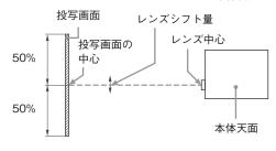
VS∪P: 垂直レンズシフト量(上) [%] VSDN: 垂直レンズシフト量(下) [%] HSR: 水平レンズシフト量(右) [%] HSL: 水平レンズシフト量(左) [%]
