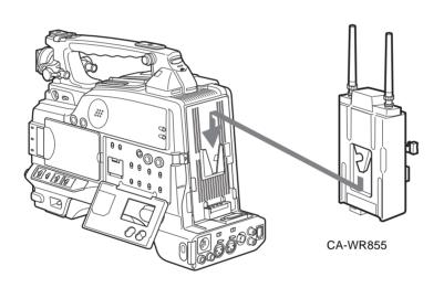
CA-WR855裏面のV金具をバッテリー取り付け インターフェースのV字溝にはめ、下方にスライドして、WRR端子に接続する。
