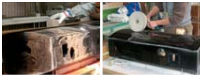
曲線状の形状によりポートノイズを低減したポート開口部 (写真はSS-AR1)
