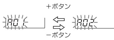
5秒間どのボタンも押さないと、自動的にグループ選択モードが解除され、表示されているグループ内で周波数の1番低いチャンネルが設定されます。ただし、ALLを選択したときは、前にALLで設定したチャンネルが表示されます。
