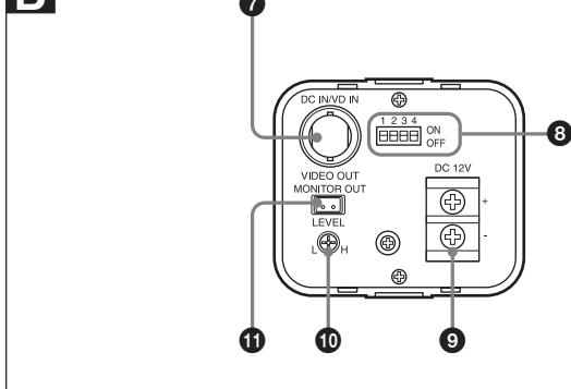
⑦ DC IN (電源入力) /VD IN (外部同期信号入力) あるいはVIDEO OUT端子 (BNC型)
