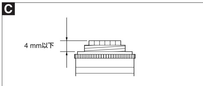
CSマウントレンズで、レンズマウント面からの突起が4 mm以下のもの (重量は1 kg以下) が使用できます。
