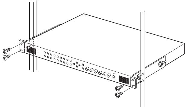
車載用途に付属のマウンティングブラケットを使用する場合は、設置環境に応じて振動や衝撃に耐えられる補強を行ってください。
