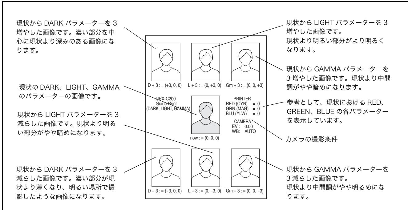
なお、各コマの下に記述されている数値は、D、L、Gm の各パラメーター値です。たとえば上図で、左上のトーンにしたい場合、(DARK、LIGHT、GAMMA) = (+3, 0, 0) ですから、D パラメーターを +3 に設定します。また、(DARK、LIGHT、GAMMA) = (+3, 0, 0) にさらに調整を行いたい場合は、D パラメーターを +3 に設定した後、再度 Guide Print-DLGm をプリントしてください。(DARK、LIGHT、GAMMA) = (+3, 0, 0) を中心に各パラメーターを変化させたシミュレーションが得られます。
