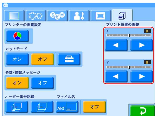
**2** [プリント位置の調整] の X (横)、Y (縦: プリント紙の排紙方向) のスライダーを [◀] [▶] ボタンで調整する。
