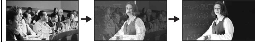
AUTO TRANSボタンを押すたび、またはトランジションレバーを動かすたびに、プログラム出力の映像とNEXT選択ボタンで指定した映像がミックスしながら切り替わります。
