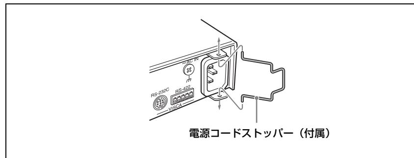
② 電源プラグをAC IN端子に差し込み、電源コードストッパーで固定する。
