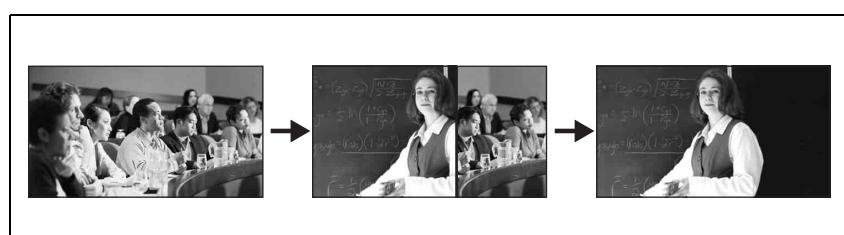
AUTO TRANS ボタンを押すたび、またはトランジションレバーを動かすたびに、プログラム出力の映像と NEXT 選択ボタンで指定した映像がワイプしながら切り替わります。
