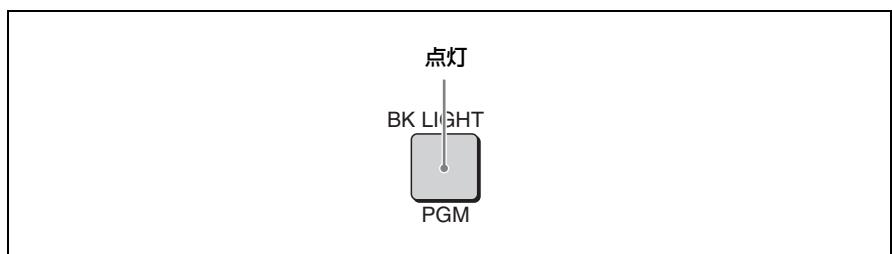
もう一度 BK LIGHT ボタンを押して消灯させると、逆光補正機能が解除されます。
