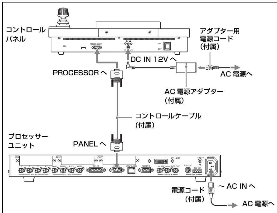
1 付属のコントロールケーブルを使ってプロセッサユニットのPANEL端子とコントロールパネルのPROCESSOR端子を接続する。
