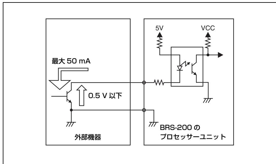
Output の例：外部ランプの接続
