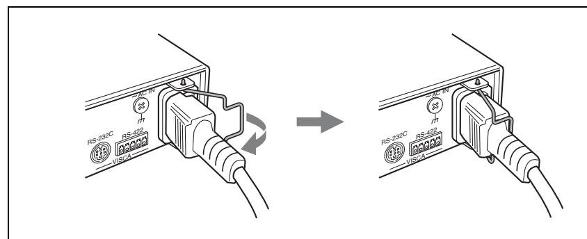
3 付属のAC電源アダプターとアダプター用電源コードを使って、コントロールパネルをAC電源へ接続する。
