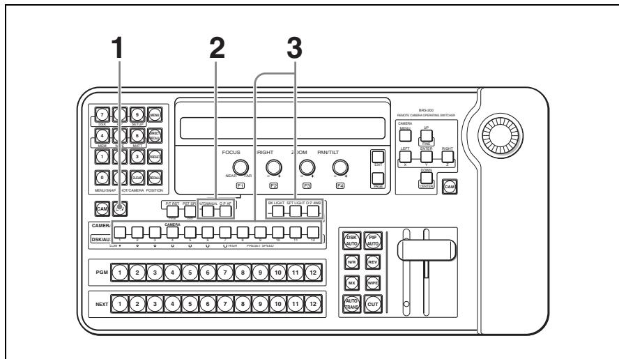
1 SW モードボタンを押して点灯させ、本機をスイッチャーモードにする。
