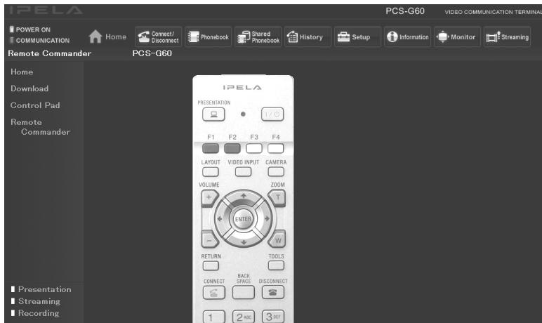
それぞれのボタンをクリックすることにより、実際のリモコン(PCS-RF1)と同様にカメラコントロール、ダイヤルなどの操作を行うことができます。
