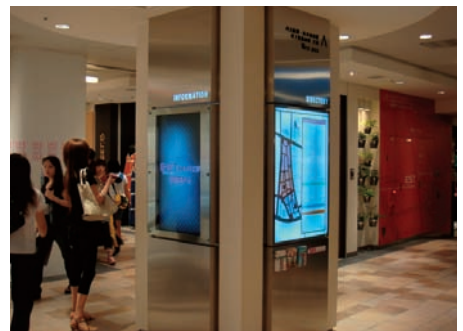
柱にスリムベゼルの42V型フルHD液晶ディスプレイを埋め込み設置。
