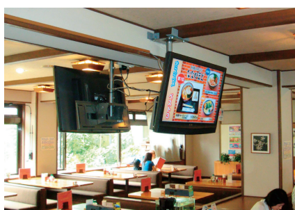
1台のVSP-NS7を使用し、背中合わせのディスプレイ2面に同一の情報を表示する。
