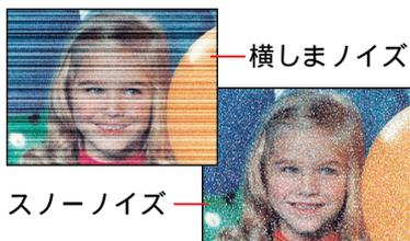
電波妨害や接触不良が起きています。アンテナ線が端子にきちんとつながっているか、折れたり切れたりしていないかを確認してください。
