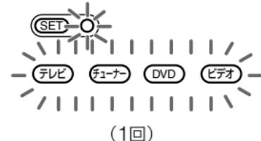
メーカー設定ロック中はメーカー設定操作が無効になります。(操作切換ボタンがすべて2回点滅します。)
