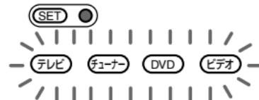
操作プログラム（コンポーネントマクロ）が登録されている操作切換ボタンが点灯します。
