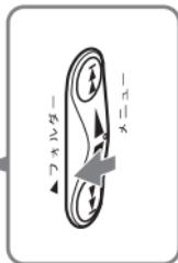
シーソーキーをフォルダ側に何度も倒して再生したい用件の入ったフォルダを表示させる。
