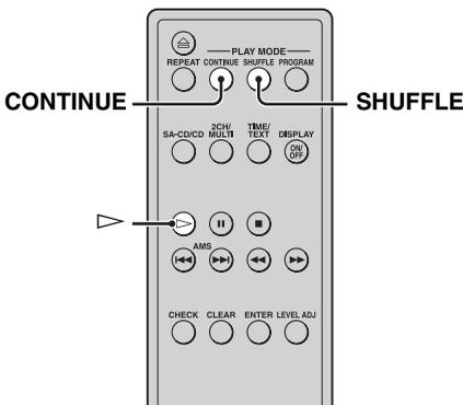
**1** 停止中に、リモコンの SHUFFLE を押す。
