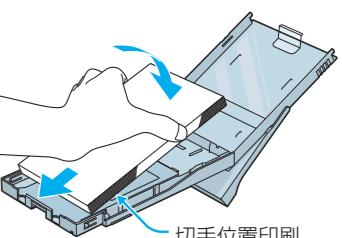
切手位置印刷（ポストカード）、給紙方向の印刷（Lサイズ）をトレイ後方（給紙方向）に合わせて、ペーパーを入れます。
