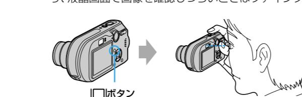
手順②の前に、コントロールボタンの▼(◎)を押す。シャッターボタンを押すと、セルフタイマーランプが点滅して「ビビッ」と操作音が鳴り、約10秒後に撮影される。
