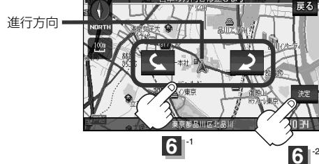
**6** 矢印をタッチして、現在地マークの方向を修正し、**決定** ボタンをタッチする。
