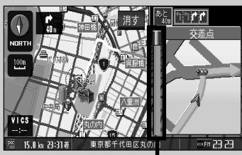
※バーの長さが短くなることによって交差点までの残距離の目安を表します。
