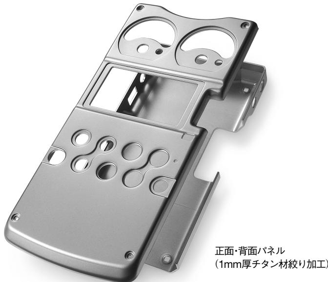
電気回路を保護する筐体には、厚さ1mmの純チタン素材を採用。「絞り加工」により、箱型に成型することで、曲げ加工やアルミ素材の絞り加工では得られない、箱としての硬さ(本体剛性)を作り出しました。音のエネルギーに触れたときに起こりやすい筐体の共振を最小限に抑え、ノイズの発生を防いでいます。
