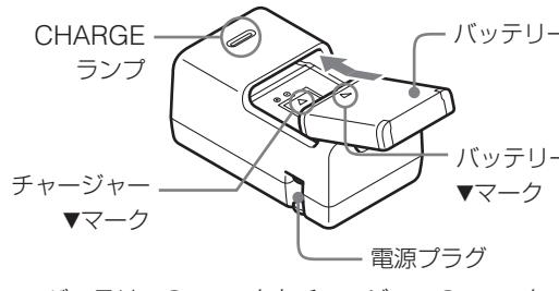
バッテリーの▼マークをチャージャーの▼マークの方向に合わせて、矢印の方向に差し込んで下さい。
