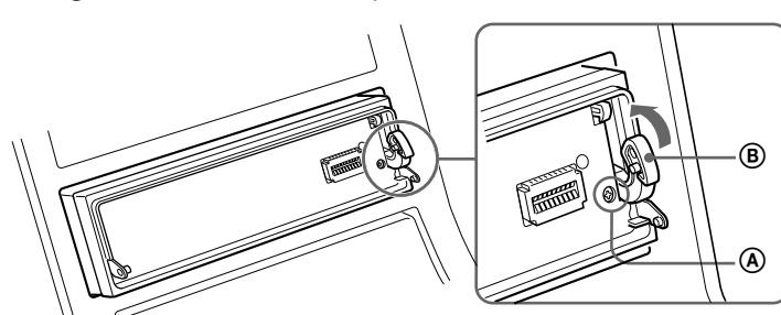
取り外したネジを取り付ける場合は、先にレバー⑧を矢印の方向にロックしてから行ってください。レバー⑧が出たままでネジ⑨を取り付けると故障する場合があります。他のネジで取り付ける場合は、下記のサイズのネジをお使いください。これ以外のサイズのネジを使うと故障の原因となります。
