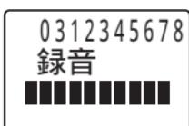
「ピー」と鳴ると、バー表示が2秒間で左から右へ1つずつ消灯します。「ピー」と鳴り、電話番号が点灯し、録音した呼び出し音声が聞こえます。
