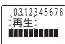
(呼び出し音声を再生しながら、バー表示が2秒間で左から右へ1つずつ消灯します。再生終了後、上の表示になります。)
