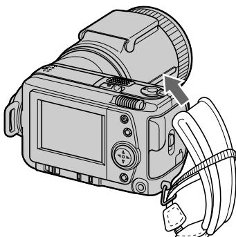
図のようにハンドストラップを取り付ける。
