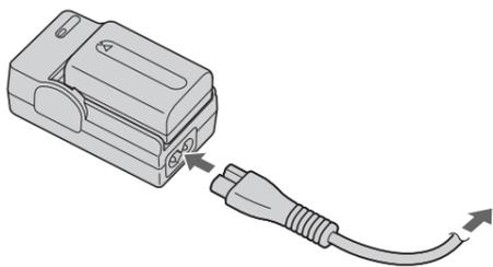
充電が始まると、CHARGEランプ(オレンジ色)が点灯します。充電されるとCHARGEランプが消えます(実用充電)。続けて約1時間充電するとさらに長く使えます(満充電)。
