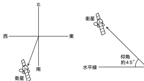
方位および仰角は地域により異なります。BSアンテナが衛星の方向から少しでもずれていると、電波を受信することができません。設置場所や向きなど、くわしくはBSアンテナの取扱説明書をご覧ください。
