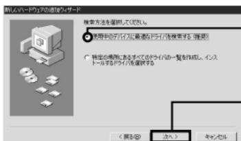
①「使用中のデバイスに最適なドライバーを検索する(推奨)」を選択。
